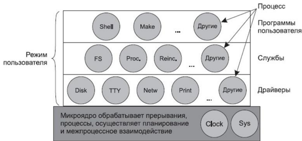
2-сурет. MINIX 3 жүйесінің жеңілдетілген құрылымы
